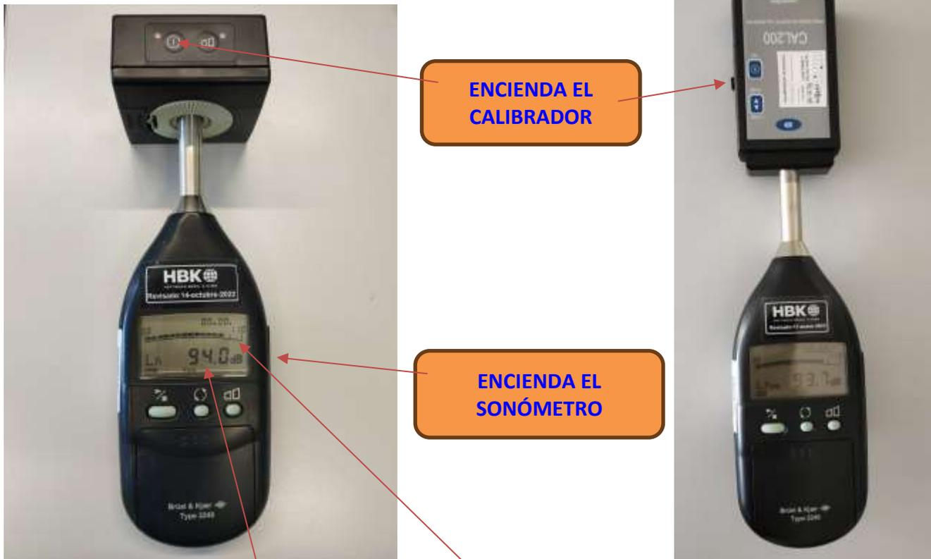
4.- Se muestra el único parámetro LAF (LA), **rango dinámico 30-110** de referencia del sonómetro que usamos para la calibración (antes había otro rango que pero en la revisiones lo anularon)
